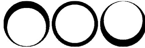
Vérifier si le boulon d'ancrage est appuyé sur la partie inférieure, supérieure, ou s'il est centré dans son trou.
