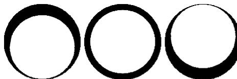
Verificar se a cavilha de fixação está apoiada na parte inferior, superior, ou se está centrada em seu orifício.
