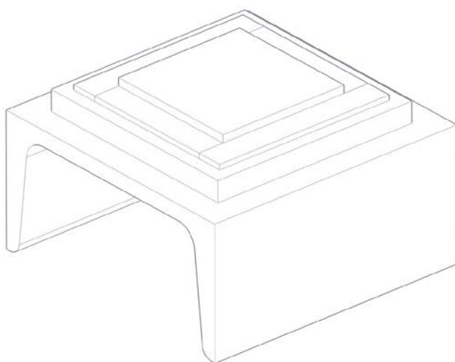
Soldar con soldadura discontinua la placa base en el lugar correspondiente según los planos de ingeniería. En la operación de soldadura debe protegerse la placa de PTFE para evitar salpicaduras y minimizar el aporte térmico para evitar que el PTFE se despegue.
